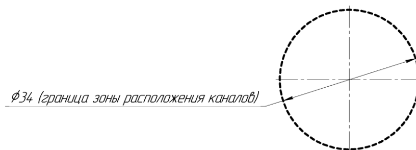
Рисунок А.2 — Эскиз сменного блока сравнения НБС-ТКП для расположения нестандартного набора каналов
